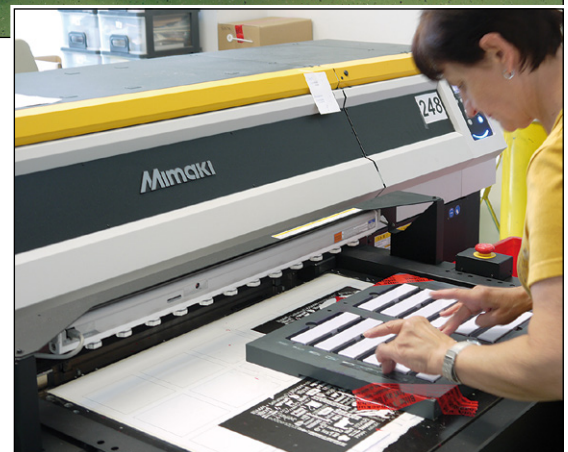
Das Bestücken der Maschine erfolgt im Nutzen.
