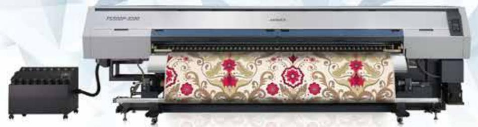
**Hohe Produktivität dank Druckgeschwindigkeit von bis zu 180 m<sup>2</sup>/h**
