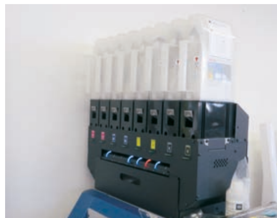
Der Mimaki-Textildrucker TS-300P-1800 wird mit Sublimationstinten in Zwei-Liter-Beuteln befüllt.
